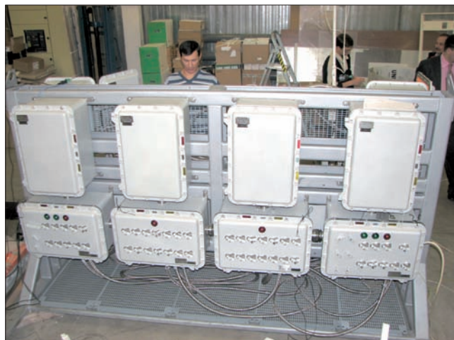
Рис. 3. Взрывозащищенное оборудование фирмы Cortem Group
